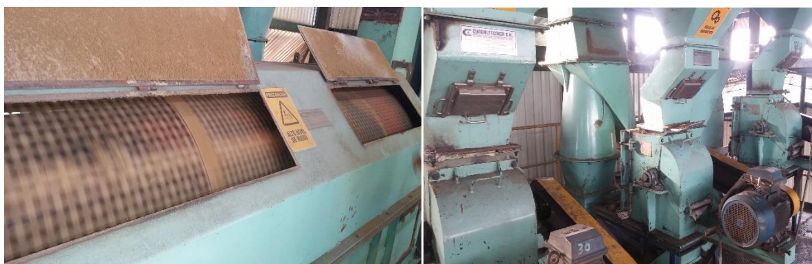
Imagen 13. Tambor clasificador y los ripple mill
